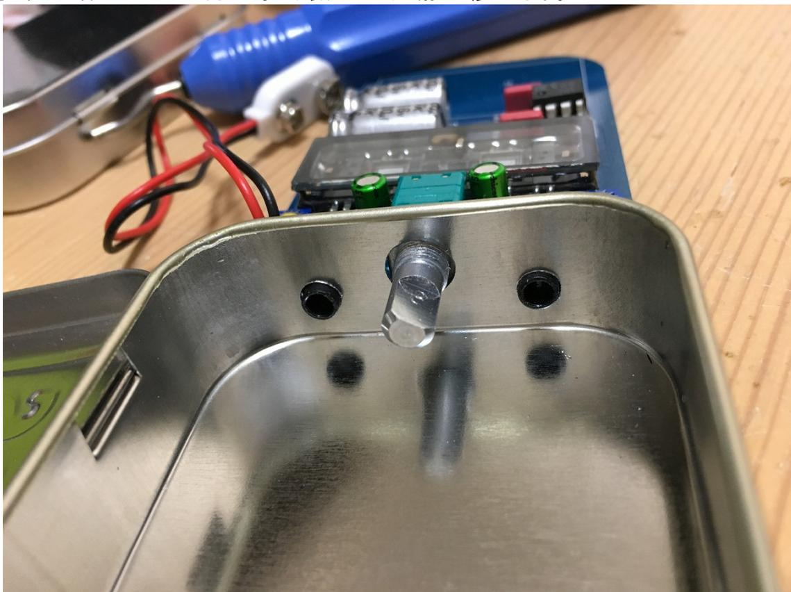
ボリュームを固定するナットが蓋と干渉するため、蓋も削ります。ワッシャーの大きさを目分量でマーキングします。
