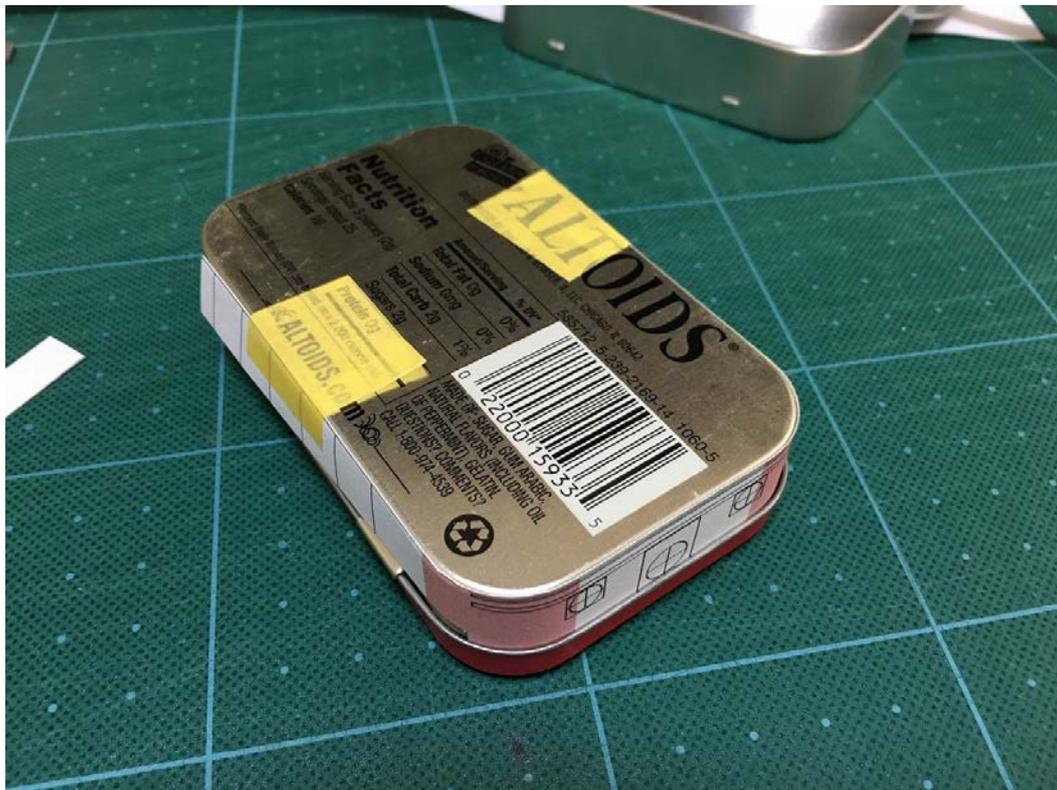
縦位置はテンプレート用紙がアルトイズ缶からはみださい場所であれば合っています。テンプレートの太いところが20mm あります。缶の高さも 20mm くらいなのでぴったり重ねれば大丈夫です。こちらも場所が確定したら、テープで固定します。
