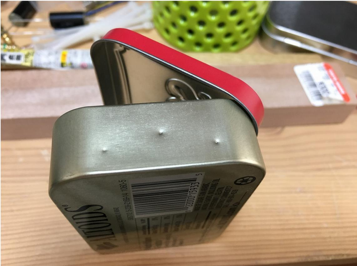
ボール盤をお持ちでしたら、5.2mm 程度の薄板用ドリルと 7.2~7.5mm 程度の薄板用ドリルで、アルトイズ缶に穴あけしてください。普通のドリルの刃でも問題なく開きますが、薄板用に比べるとバリが出る量が多いようです。
