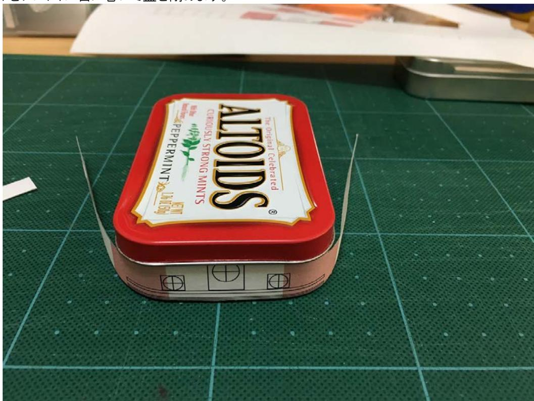
直角の定規(曲がり尺や三角定規)で両側面の縦線が同じ位置にあるか確認する。そうすることで穴あけの横位置は確定します。
